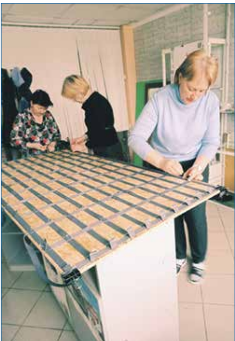
Изготовление бескаркасных многофункциональных носилок
